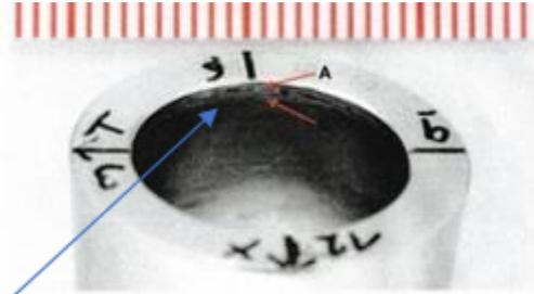
Abb. 10: Der Adapter-Innenkonus zeigt eingangsseitig unverschlossene bzw. undeformierte Bereiche (A), an die sich eine Verschleiß-/ Deformationszone anschließt (B).
